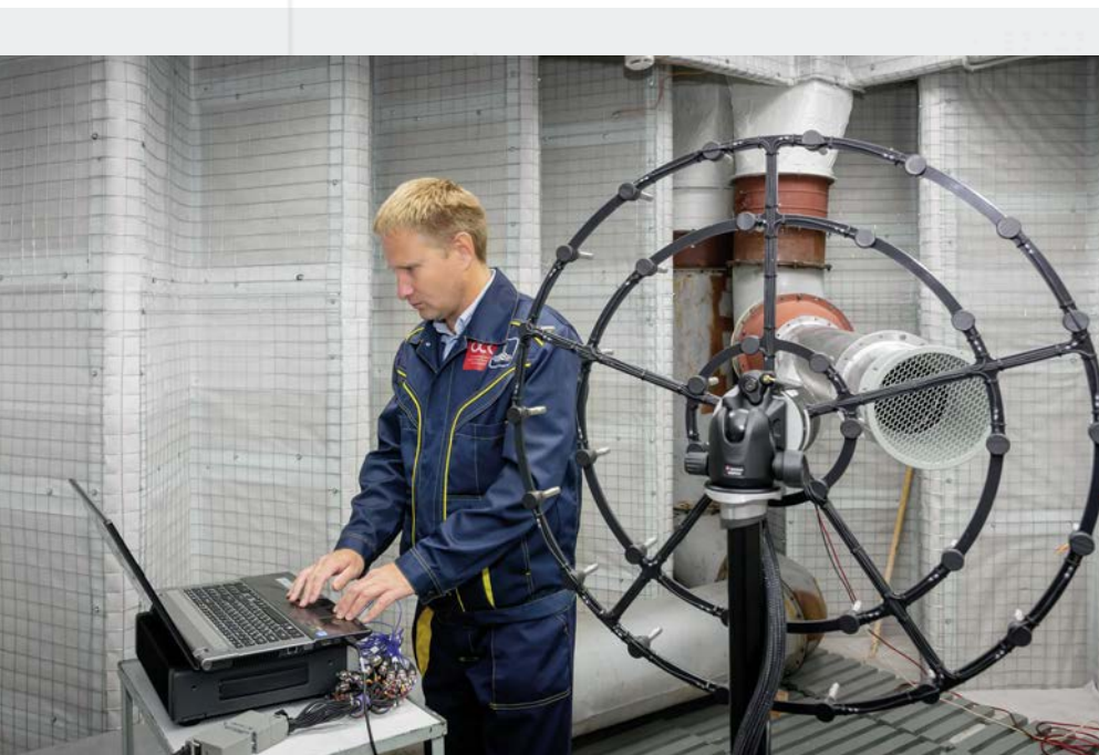
Физик-акустик измеряет уровень шума в акустической камере с помощью микрофонной решётки
